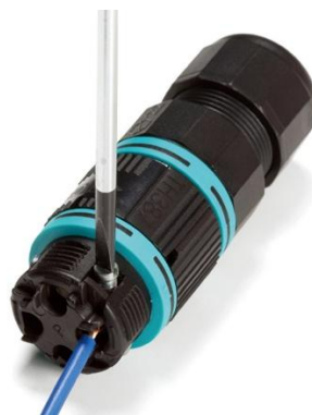
マイナスドライバーでの締付け(トルク値: 最大 0.8\text{N}\cdot\text{m} )
