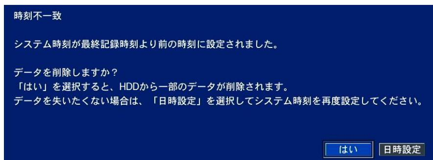
新しい日時をそのまま適用してデータを削除するか、日時設定を変更前の状態に戻すかを選択します。
