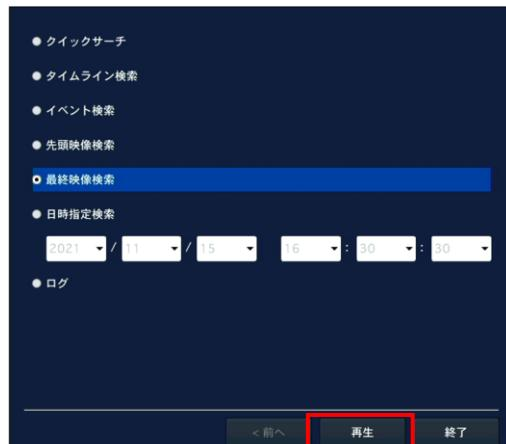
検索メニューで、「最終映像検索」を選択し、「再生」をクリックすると、HDD に保存されているデータのうち最も新しい 1 分間の録画データを再生します。
