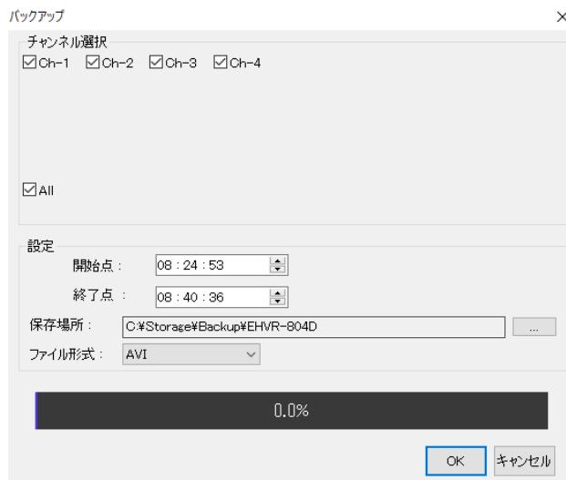
6. 「チャンネル選択」にてバックアップを行うチャンネルを選択します。
