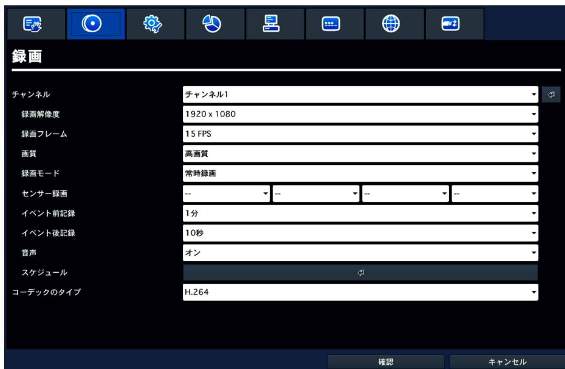
「チャンネル」の項目にて、プルダウンボタンをクリックし、設定するカメラチャンネルを選択してください。
