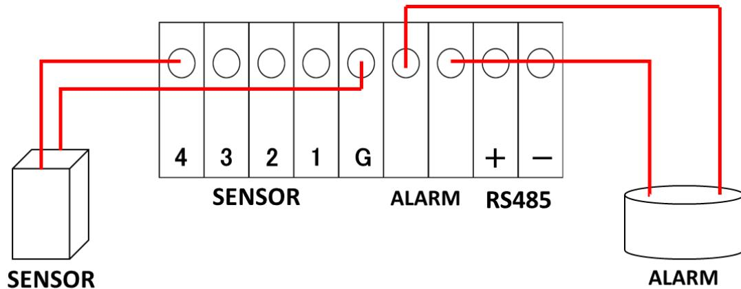
N/O : Normally open type sensor. 通常はオープン状態で、クローズしたら反応します。
