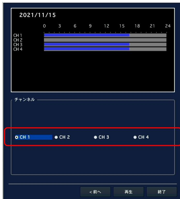
4. 再生を開始する時間帯(サムネイル)を選択しダブルクリックします。
