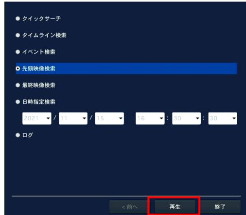
検索メニューで、「先頭映像検索」を選択し、「再生」をクリックすると、HDD に保存されているデータのうち最も古い録画データを再生します。
