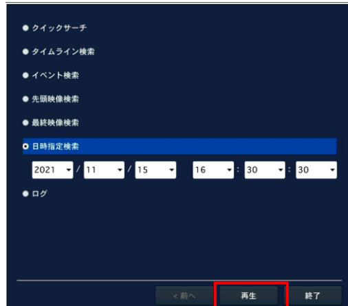
検索メニューで、「日時指定検索」を選択し、検索したい録画データを年/月/日/時/分/秒で指定します。指定後、「再生」をクリックすると、指定された日時からの録画データを再生します。
