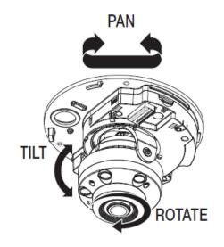
4. ドームカバーを取り付けて、右図のように回してしっかりと 固定してください。
