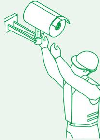
「いざ」という時の撮り逃しを防ぐには、年1回程度、機器のメンテナンスを行うのがおすすめです。ケービデバイスの点検では、機器の動作確認に加え、簡易な清掃も行います。
