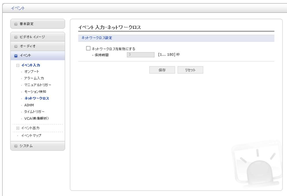
本機と直接接続している機器とのネットワーク接続が切れたことを検知してイベント出力を行います。
