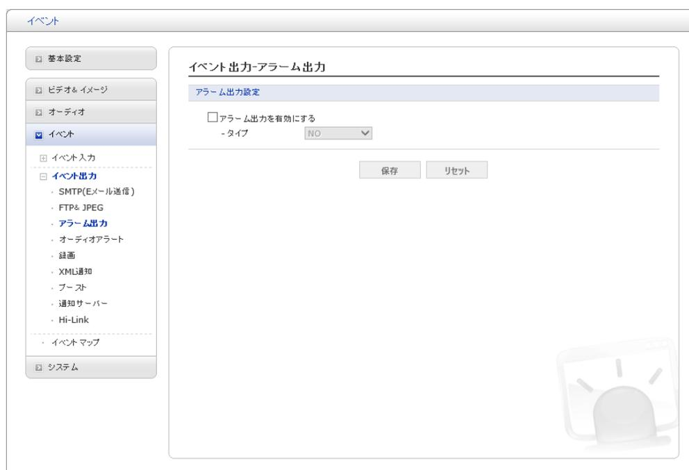
イベントが発生した際に接点を作動させてアラーム信号を出力します。
