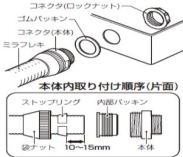
手順① ミラフレキに袋ナットをはめ、ストップリングを管端から10~15mmの位置にはめ込みます。
