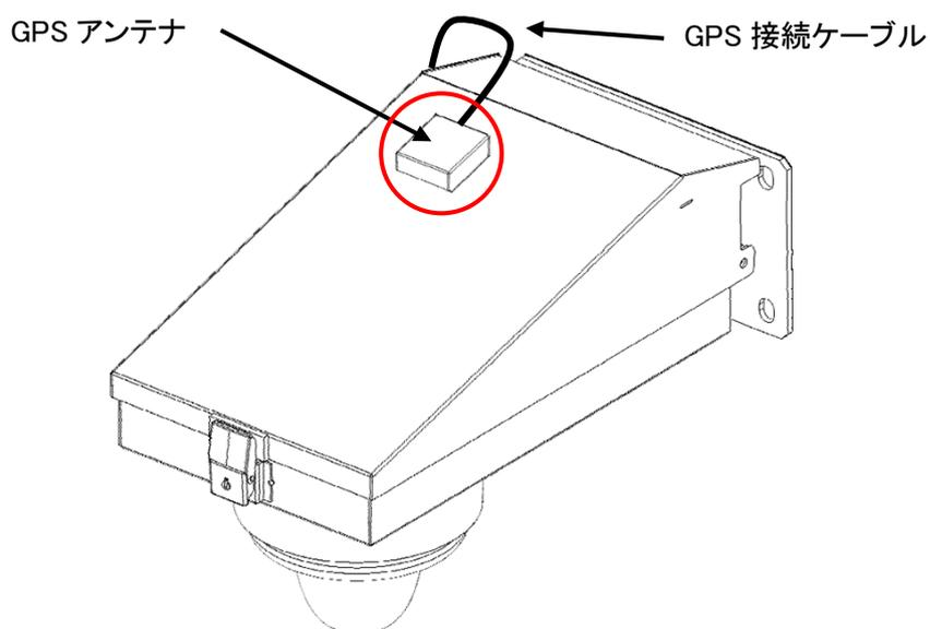
本製品の側面や底面への取り付けは、接続ケーブルの断線や GPS 通信不良の恐れがあるため
