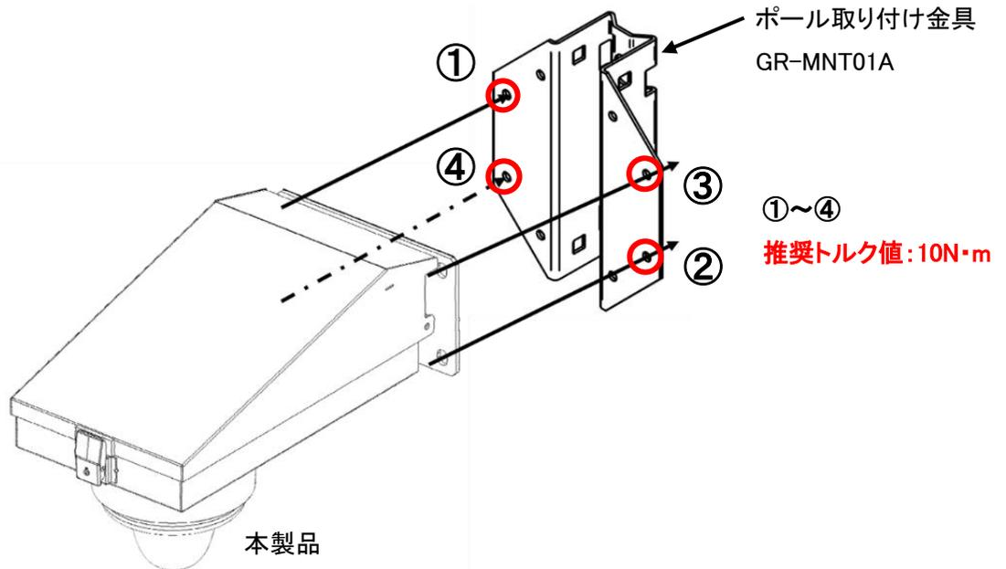
専用ポール金具へ取り付ける際は、以下の図のようにボルト・ワッシャーなどを使用してしっかりと固定してください。
