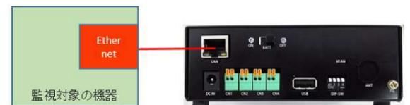
※ 監視対象の機器には、Ping応答を有効にする設定をしてください。
