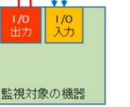
※監視対象の機器には、「接点入力(N/O)がONになれば、即座(1秒未満)に接点出力(N/O)をONにする」設定をしてください。
