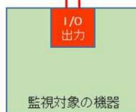
※ 監視対象の機器には、障害発生時に N/O で接点出力をおこなう設定をしてください。
