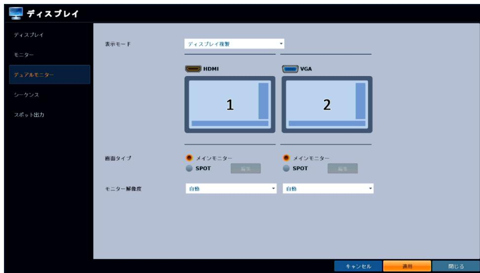
HDMI と VGA にて同時出力する際に、メイン・スポットモニターのどちらで表示するか設定できます。また、スポットモニター側のライブ画面の表示パターンを設定できます。
