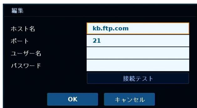
3. < ユーザー名 >および< パスワード >欄をダブルクリックし、バーチャルキーボードより設定先の FTP サーバーにアクセスするためのユーザー名とパスワードを入力します。
