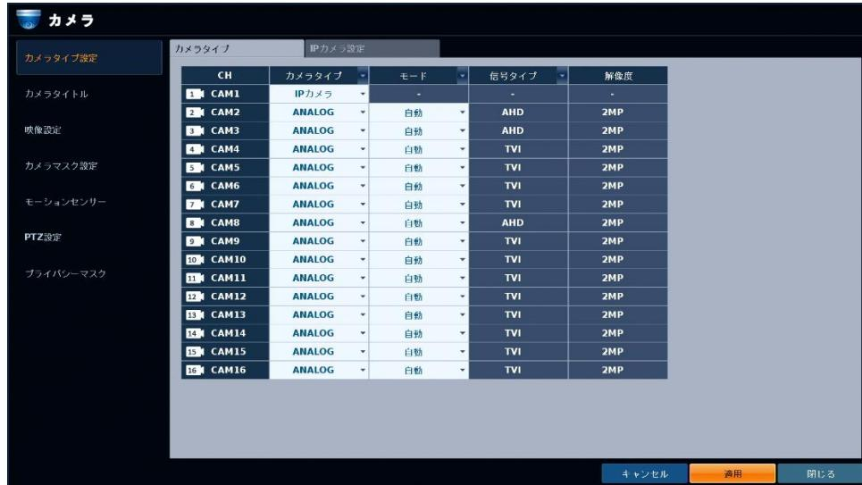
本機の各 CH に入力するカメラタイプを設定します。
