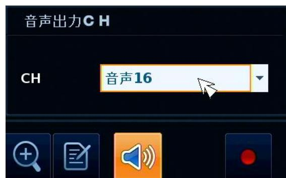
例：本機背面の< AUDIO IN 16 >端子にマイクを接続している場合は、< 音声 16 >を選択します。
