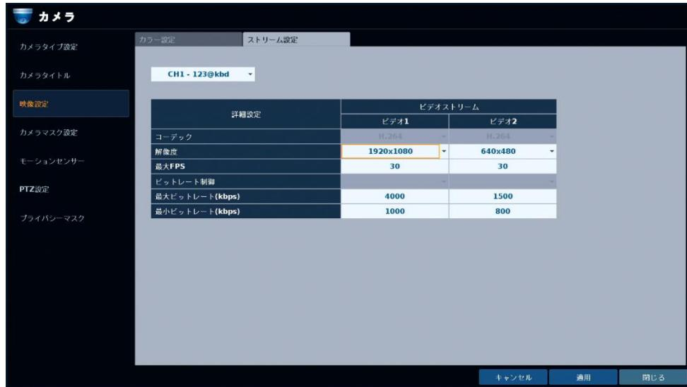
IP カメラを登録している CH に対して表示解像度やフレームレートを設定できます。
